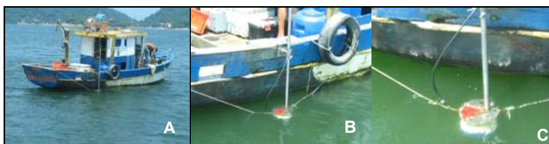
(A) embarcação Korio Maru I fundeada em um ponto de medição, (B) e (C) detalhes da fixação do ADCP na borda
