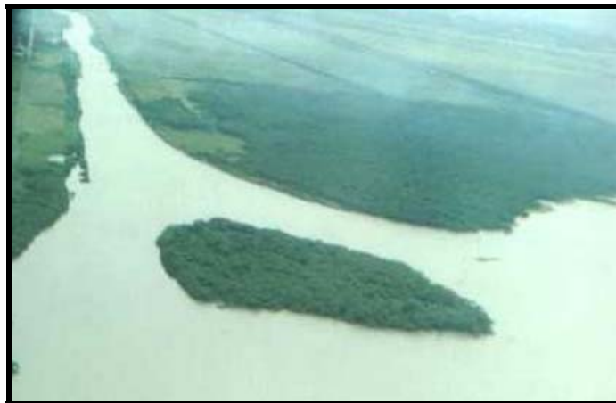
Figura 6.1.7-8 - Foz retificada do Canal de São Francisco, notando-se a ilha criada pela descarga sólida e a deriva do delta, como função da corrente preferencial no sentido Leste.
