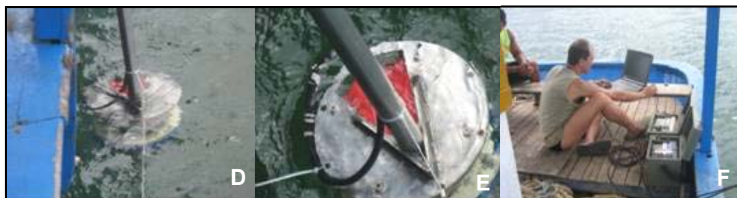
(D) e (E) ADCP imerso e (F) “setup” do instrumento
